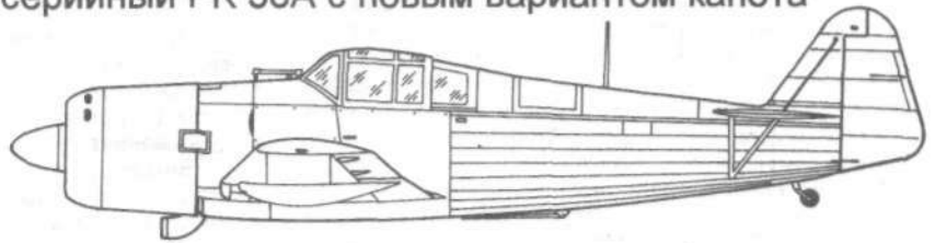
6-й серийный FK 58A с новым вариантом капота
